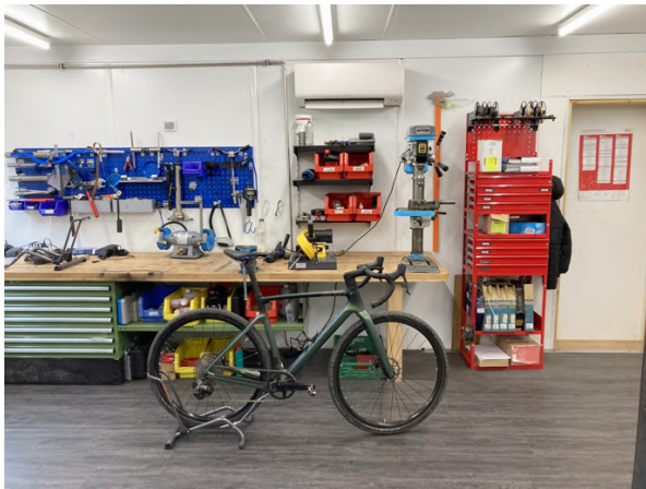
Abbildung 8: Gebäude 1 (Werkstatt). Die Klimaanlage wird bereits am Vorabend so programmiert, dass bei Arbeitsbeginn die gewünschte Innentemperatur vorherrscht.
